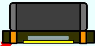
Cuポストが熱を実装基板へ放熱
